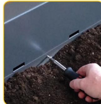
Lösen Sie die Halte-Schrauben (Torx), die mittig in den einzelnen Ebenen platziert sind.
